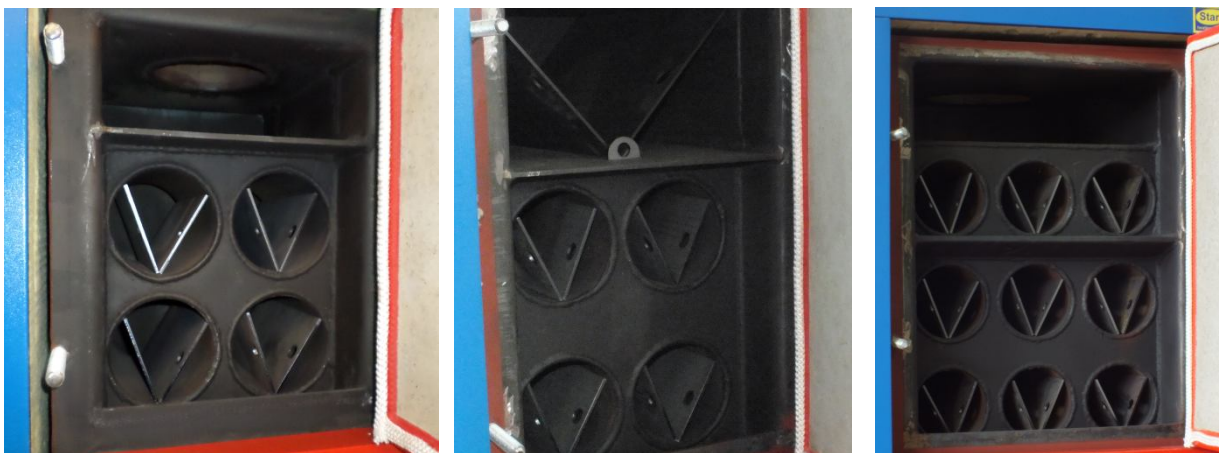
Рисунок 4 – Схема установки турбулизаторов
